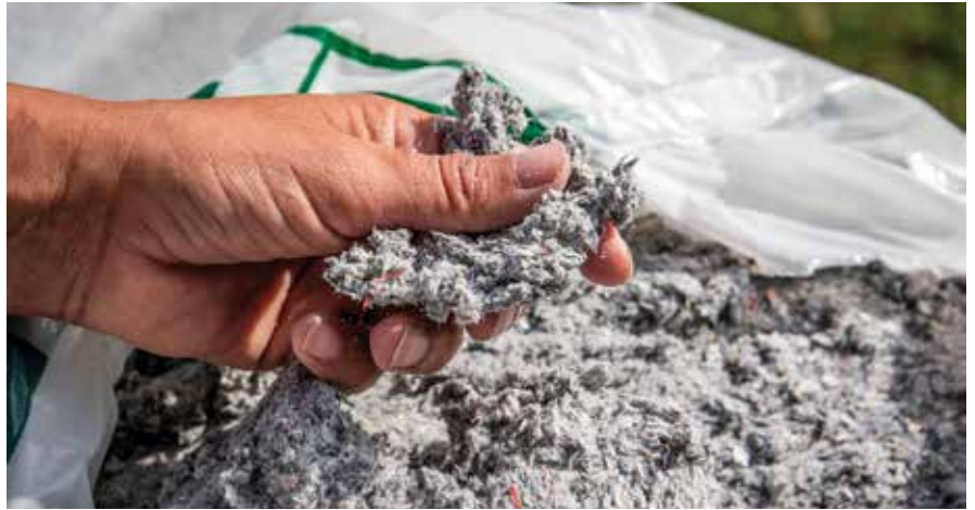
Loose-fill (cellulose) insulation.
